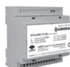
**5-Stufen-Trafo ST5-230V** (#99332) mit Gehäuse, 4 Sekundärspannungen (80/100/125/175 VAC/50Hz) und 230VAC/50Hz ermöglichen 5 Leistungsstufen. Einbau auf EN-Tragschiene.
